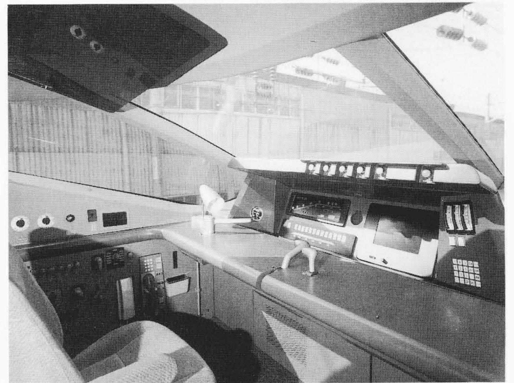
図11 300系新幹線電車の運転室内部 内部機器配置のシンプル化を図り、前方を注視しやすいようにした。
