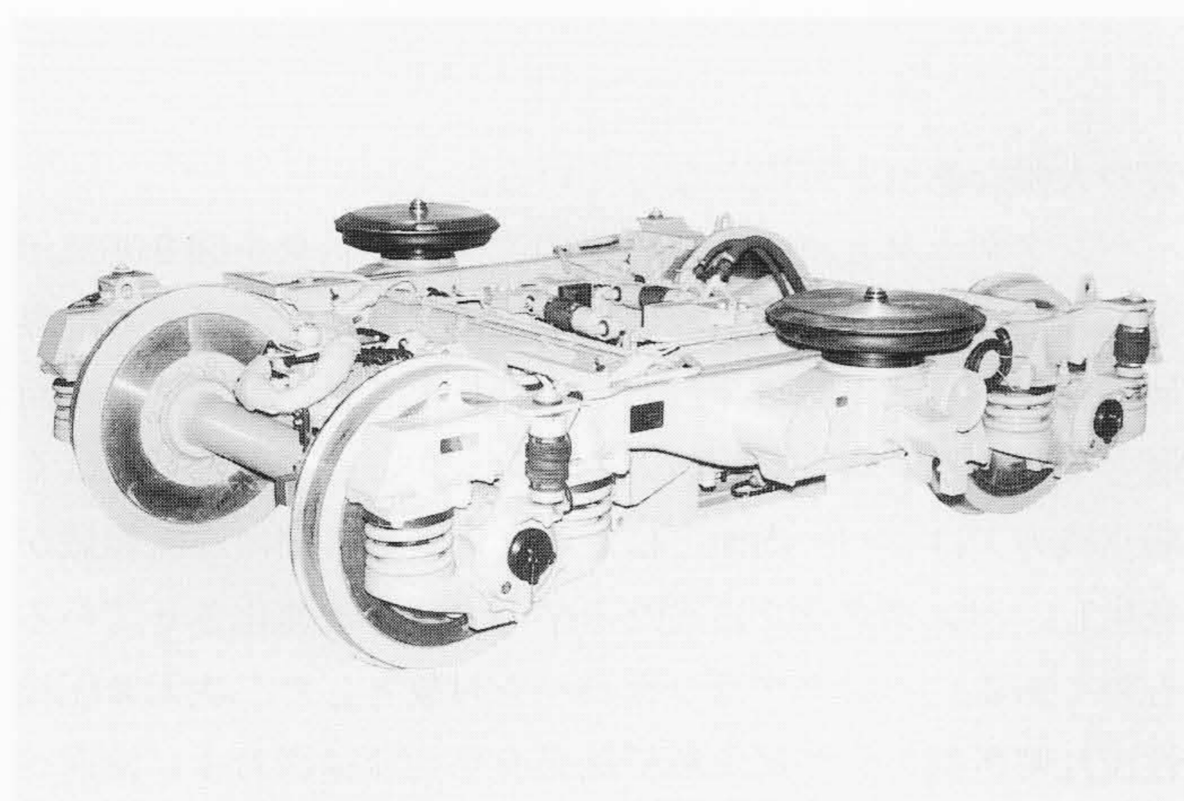
図5 300系新幹線電車用TDT203台車 ボルスタレス車体支持方式とし，端ばりを廃止した高速・軽量台車である。
