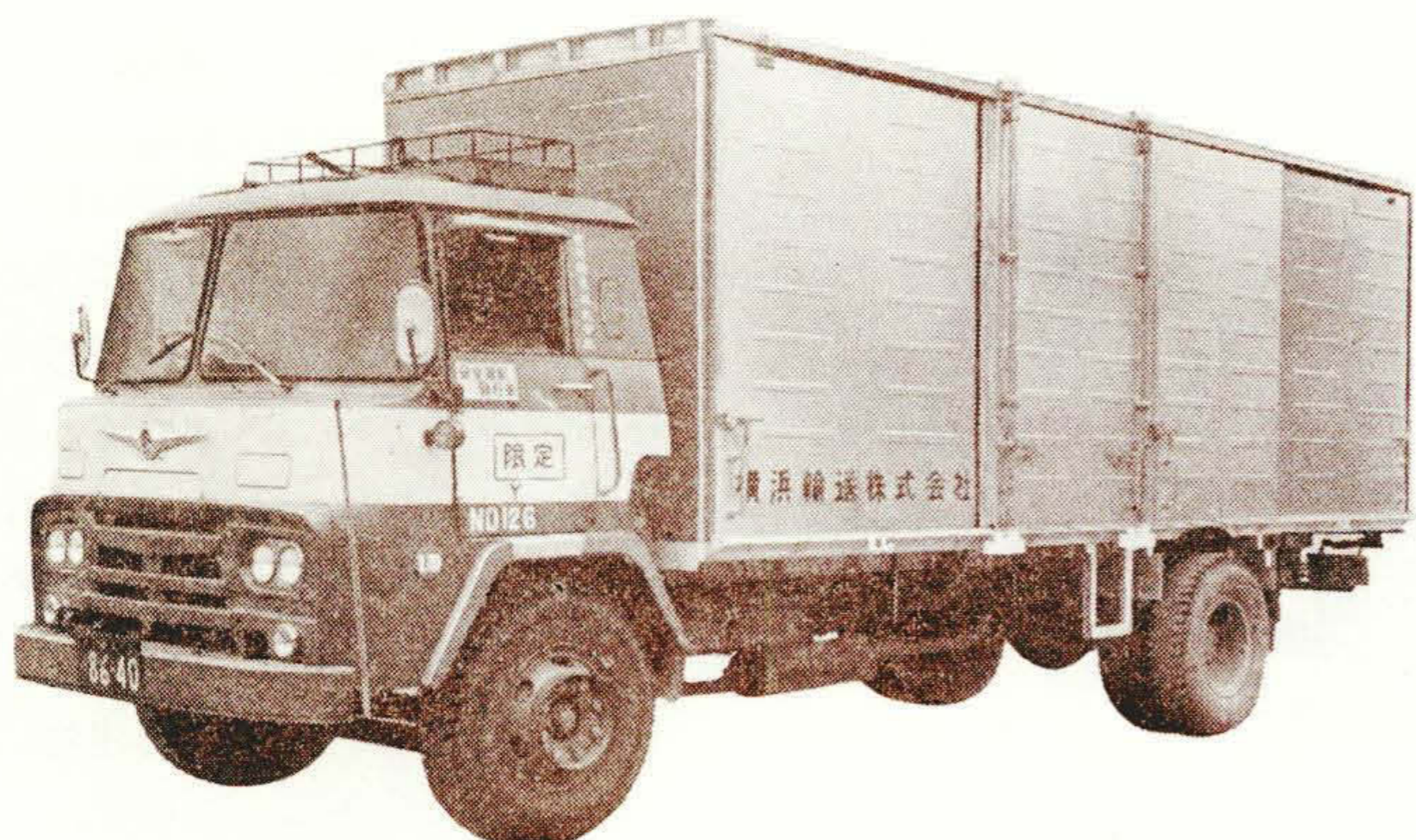
第9図 パレット輸送用アルミバントラック
