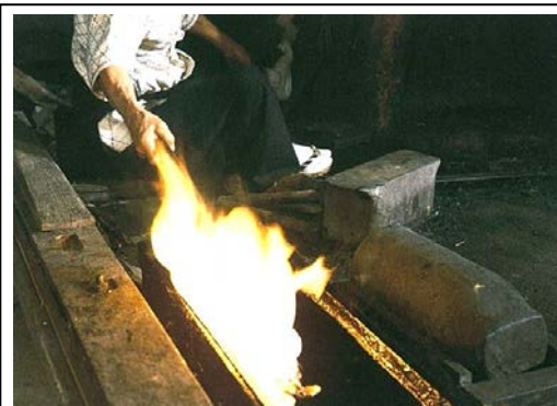
第5図 鋸の油焼入れ (竹中大工道具館 2009 10頁より)
