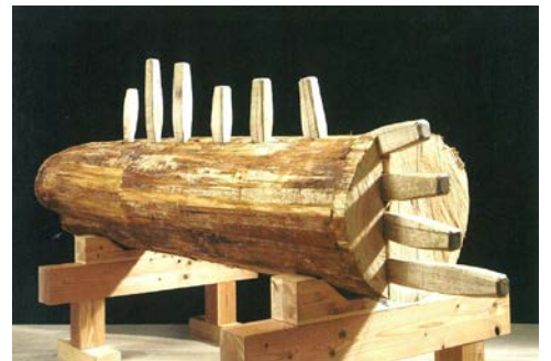
第13図 実験・古代の打割製材 (竹中大工道具館 2014 16頁)
