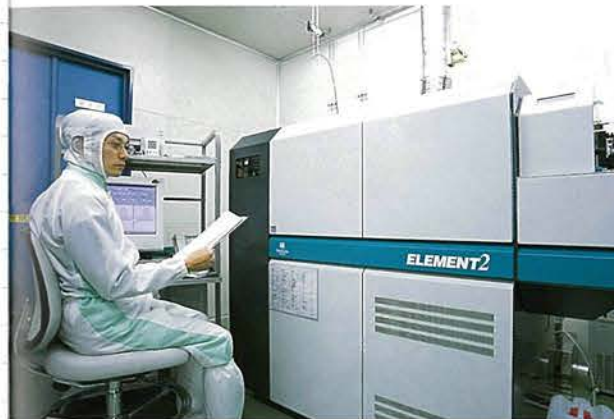
誘導結合プラズマ質量分析計・ICP-MS。このほか、安定同位体比質量分析計なども活躍する
