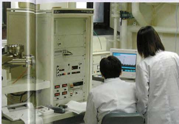
最新の分析機器を使って、岩石の特性をさまざまな角度から解析していく。写真は表面電離型質量分析装置による岩石・堆積物中の同位体測定をしているところ
