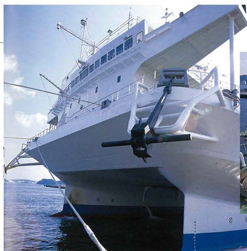
ユニークな船体。水中に隠れている魚雷型のがっしりとした没水船体と比べると、足(ストラット)はとてもスマートに見える
