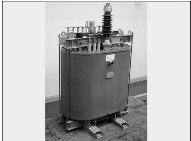
図31 車両用超電導主変圧器
