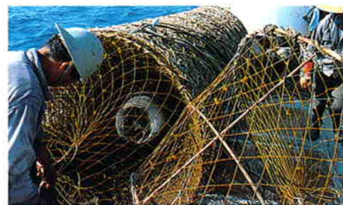
ベニズワイガニ用の籠網（日本の水産「蟹」より）
