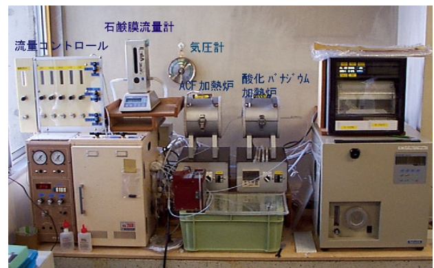
写真1 固定床流動反応装置
