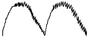
図 2-2 コンデンサのリプル電流波形
