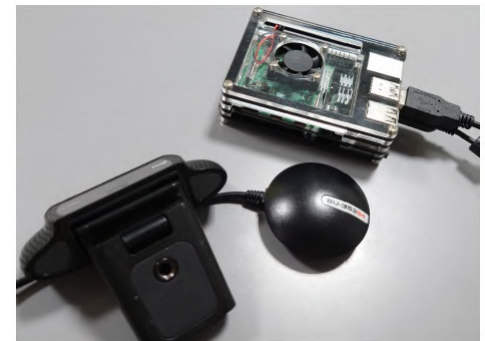
写真1. 車載カメラ画像の画像処理機器
