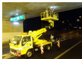
トンネル点検車
