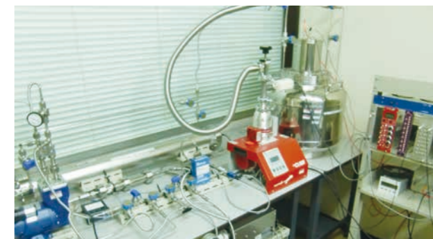
図2 船橋キャンパスの放射能計測装置。ラドン検出器と比例計数管から構成されている。
