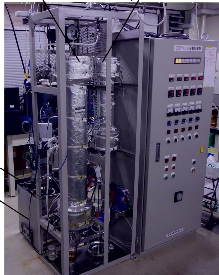
ヒーター方式による 脂肪酸 リッチ油 用ベンチシステム(5L/day)
