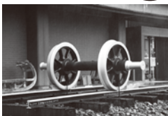
ドイツクルップ社 1890年製 22Kレール貨車の車輪
