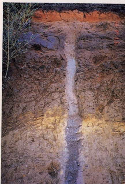
図-12 鬼界アカホヤ噴火時に起こった地震による液状化を示す岩脈 6) 上の写真は屋久島、下の写真は大隅半島吾平町 6)
