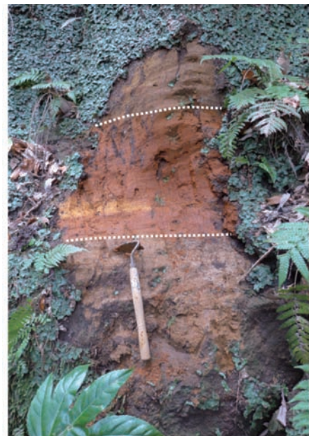
写真-3.1.5 弘タフリングに挟まれる箱根Da-4軽石 (白い破線と破線間のオレンジ色の層, 地点916)
