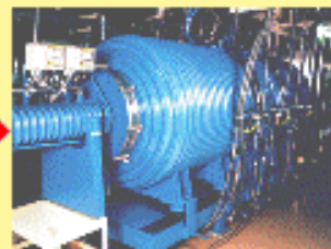
焼結工程 約1700℃でペレットを焼 き固めます。
