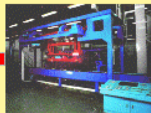
ワイヤ巻付工程 ピンにワイヤを巻付けま す。
