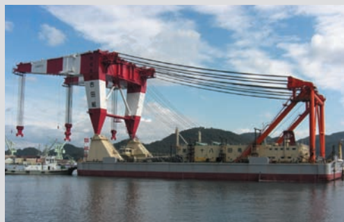
第28吉田号（飛行航路を考慮して低くつくられている）
