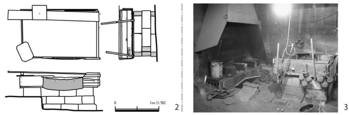
도면 2. 봉화유기공방 시설배치(1), 작업대 실측도(2), 작업대·건조장·용범 고정장치 (3 : 쇼다신야 촬영)
