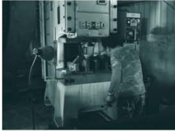
사진 25 구연부를 프레스 하는 모습 (거창)
