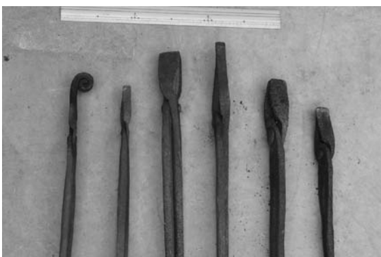
写真15 加熱炉出し入れ用道具（先端）
