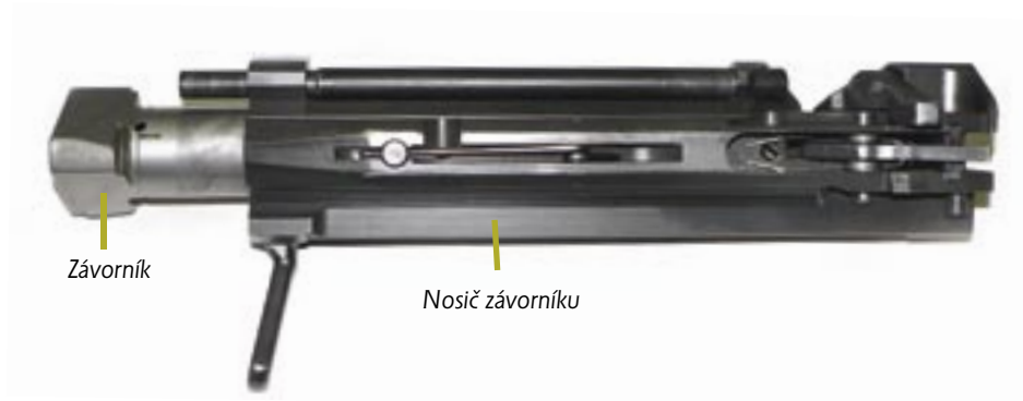
Detail závěru 12,7mm odstřelovačské pušky Barrett M82A1
