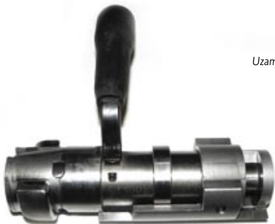
Detail sestavy závěru 12,7mm odstřelovačské pušky Falcon OP 99
