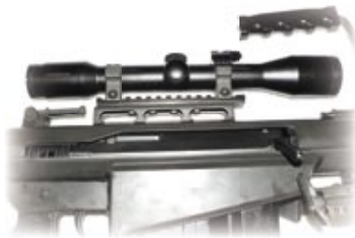
Detail montáže zaměřovacího dalekohledu 12,7mm odstřelovačské pušky Barrett M82A1
