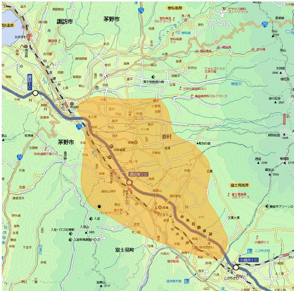
※1 エリアは、電波法令に規定する「放送区域」を表しており、地上10メートルの高さで、送信所からの放送波の電界強度が1mV/m以上得られる区域として算出されたものです。
