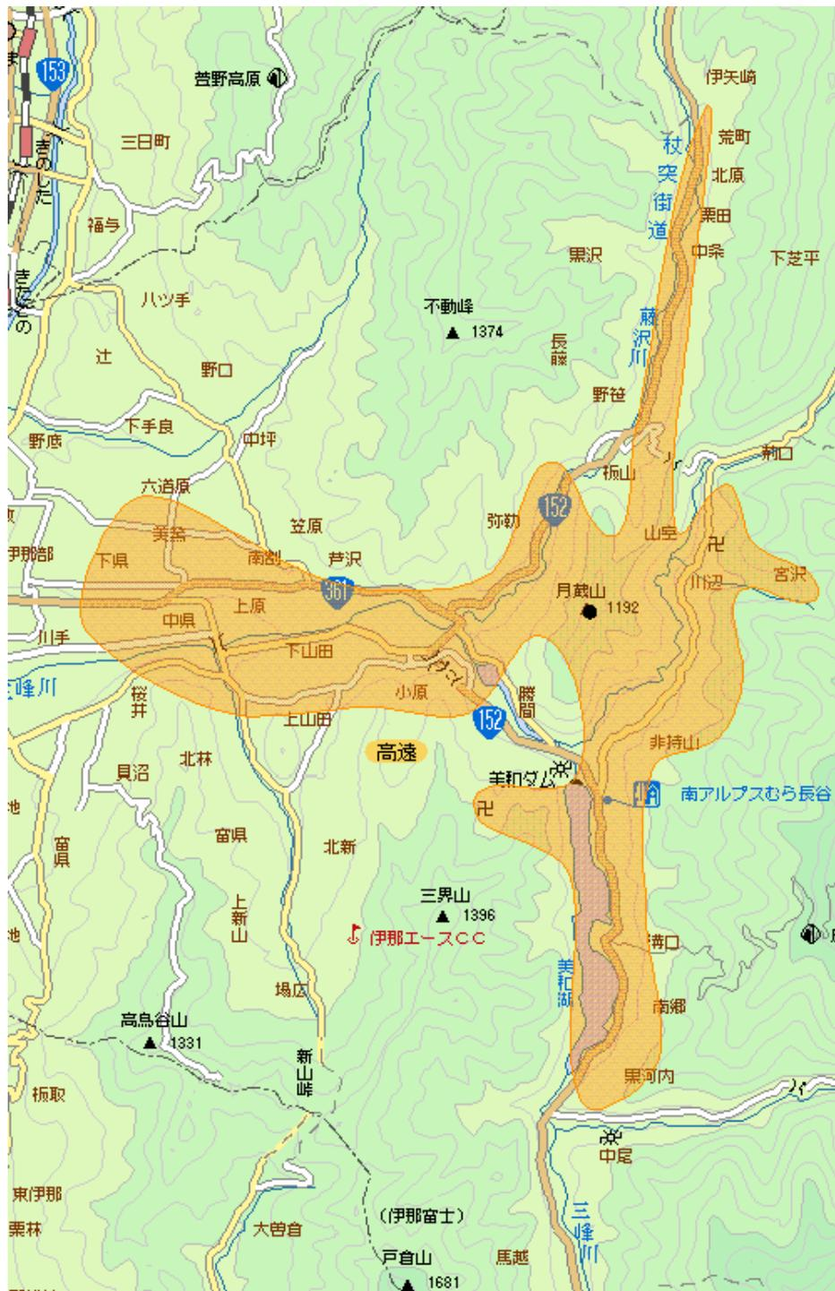
※1 エリアは、電波法令に規定する「放送区域」を表しており、地上10メートルの高さで、送信所からの放送波の電界強度が1mV/m以上得られる区域として算出されたものです。
