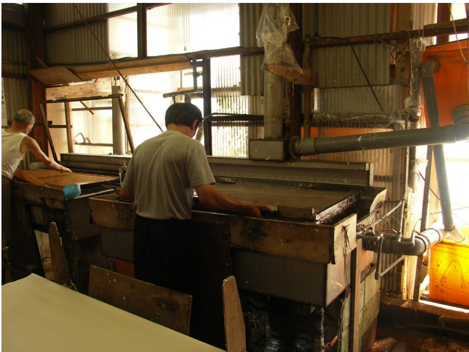
写真2 因州の半自動式手漉き装置
