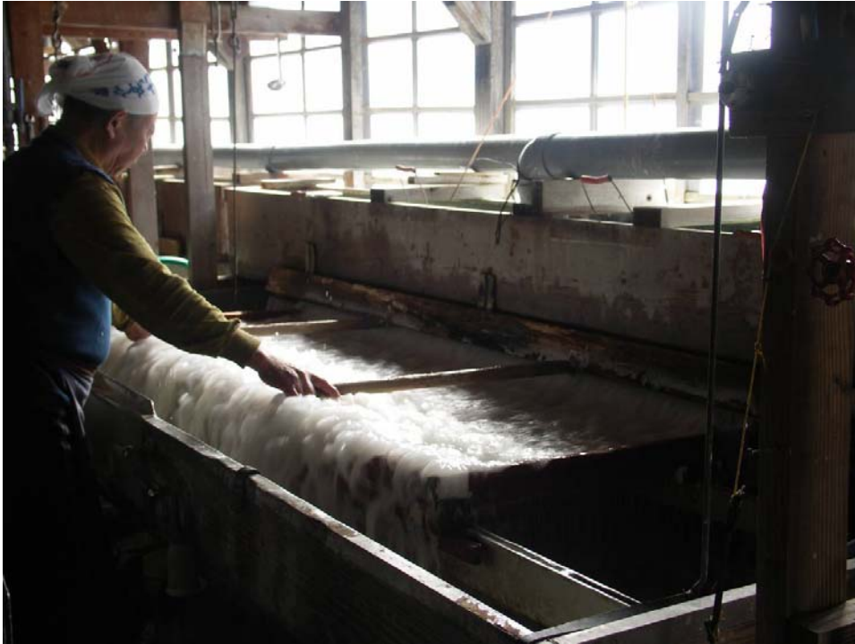
写真1 西島のセイコー式手漉き装置
