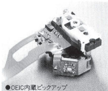
図 7.5 非球面単玉樹脂レンズを使用した PU の外観写真
