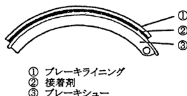
図 6.17 ドラムブレーキライニングとブレーキシューの接着接合 18)
