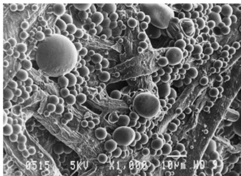
図7.2 紙表面のカプセルとでんぷん粒子（ステイ剤）
