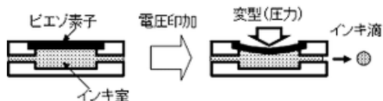
図 8.2 ピエゾ方式オンデマンド型インクジェット装置
