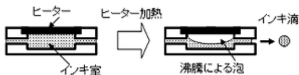
図 8.3 サーマル方式オンデマンド型インクジェット装置
