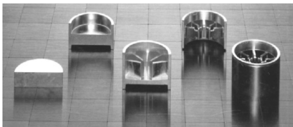
図4.21 陽極のホビング加工 (写真 日立協和エンジニアリング)
