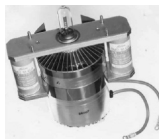
図4.18 強制空冷パッケージ型マグネトロン2M52 (写真 ホクト電子)
