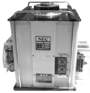
図5.14 地球局用30GHz/500Wクライストロン28AV81 (写真NTT情報流通基盤総合研究所)
