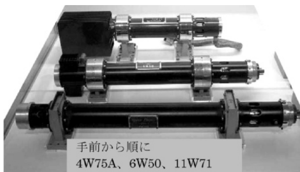
図6.6 NTT商用中継器用PPM進行波管 （写真：NTT情報流通基盤総合研究所）
