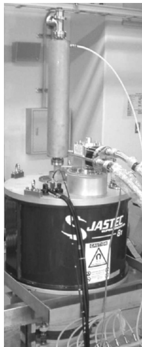
図7.7 福井大FUCW II 395GHz/100W ジャイロ トロン（写真：福井大）
