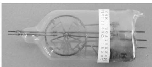
図4.10 受信機局発用マグネトロンM60 (写真 日本無線)
