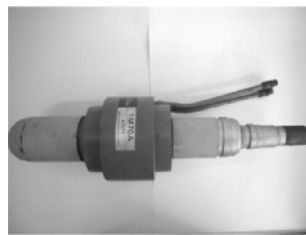
図4.23 915MHz 30kW 連続波マグネトロン1M70 (写真 東芝電子管デバイス)
