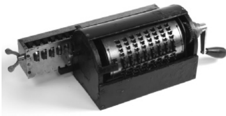
写真3.2 矢頭良一の2-5進法機械式計算機「自動算盤」(久富家所蔵)
