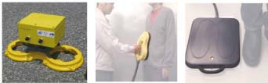
図6 差分コイル型アンテナを内蔵したNQR地雷探査用プローブ(左)、身体検査用プローブ(中)、靴検査用プローブ
