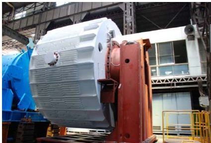
3MW / 15rpm 初号機工場試験状況
