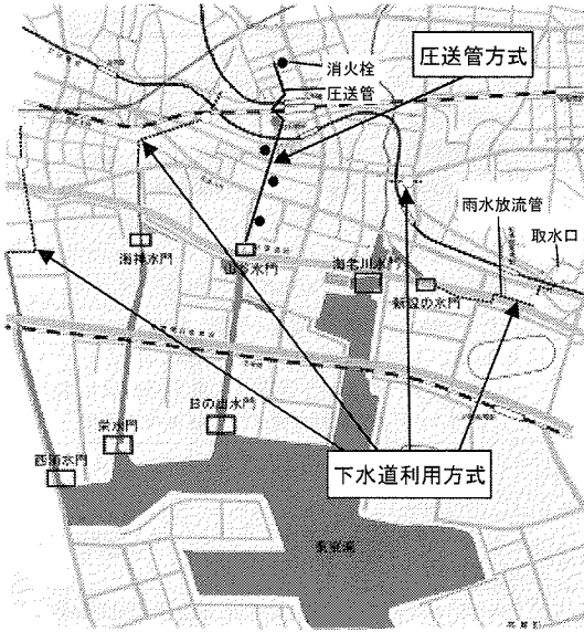
図-5 船橋市の海水等を利用した大規模消火システム
