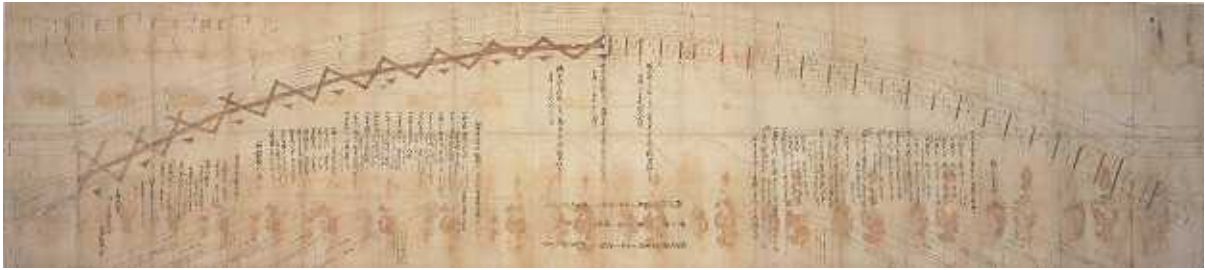
現存する最古の錦帯橋構造図（1699年）
