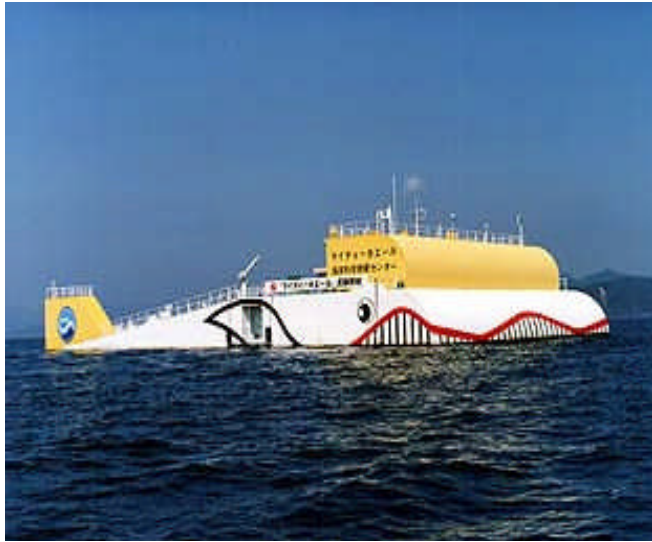
図16 マイティホエール 振動水柱型波力発電浮体(出典:海洋研究開発機構) 図17 海陽 (出典:日本造船振興財団)
