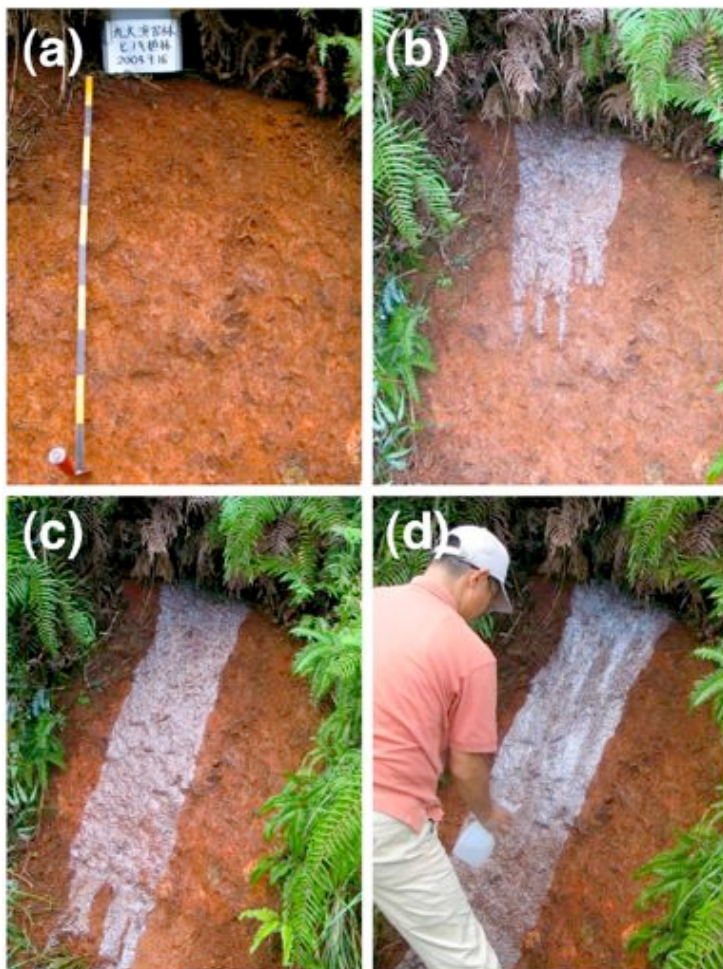
図 8.2 モノリス製作の詳細（その1）：(a) 土壌断面の表面をできるだけ平らに整形する，(b) 接着剤を塗布している様子（塗布するポイントは，土壌断面に角度を付けることです。土壌断面の上から接着剤を流すときは流しすぎに注意する。）(c) 接着剤を流しすぎると下部に接着剤がたまるので注意が必要（土壌断面下部より，刷毛で土壌断面上部に向かって，接着剤を塗布する方法もある），(d) 接着剤を固化させるために霧吹きを用いて水を吹きかける
