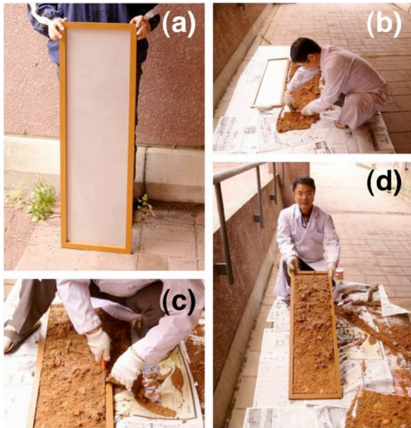
図8.4 モノリス製作（その1）：(a) モノリスの枠を用意します（ベニヤ板と角材で作製しますが、今回はアルミ版を使用しました），(b) はがしとった土壌断面フィルムを枠にあわせてカッターナイフでゆっくり切る，(c,d) 枠にはめながら，ゆっくり切っていきます，モノリス製作協力（筑波大学大学院生 梅原温）
