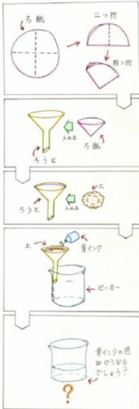
図 7.6 土壌の吸着性を調べる実験の手順
