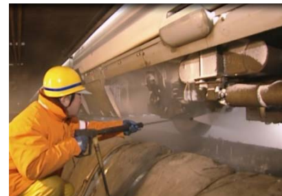
図8 高圧洗浄機を使用した雪落とし作業
