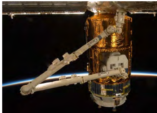
ISSのロボットアームで、曝露パレットをHTV補給キャリア非与圧部から取り出す写真
