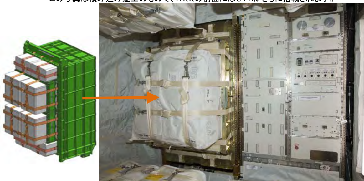
図1.6.1-5 ラック前面へ搭載された物資輸送用バッグ(CTB)の例 (HTV2) (右側は温度勾配炉(KOBAIRO)ラック)
