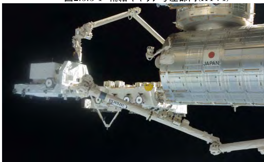
図2.5.3-2 ロボットアーム同士での曝露パレットの受け渡し(HTV1)
