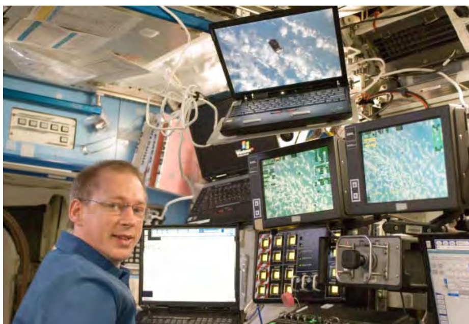
図2.5.2-3 HTVを把持する際に使われるロボットアーム操作卓(HTV1)
