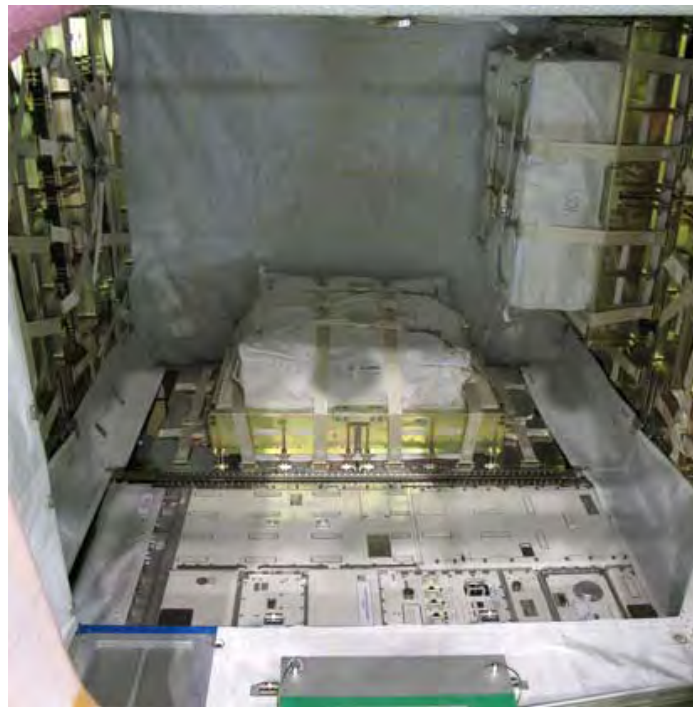
図1.6-1 HTV補給キャリア与圧部(補給物資の積み込み途中)(HTV2)
