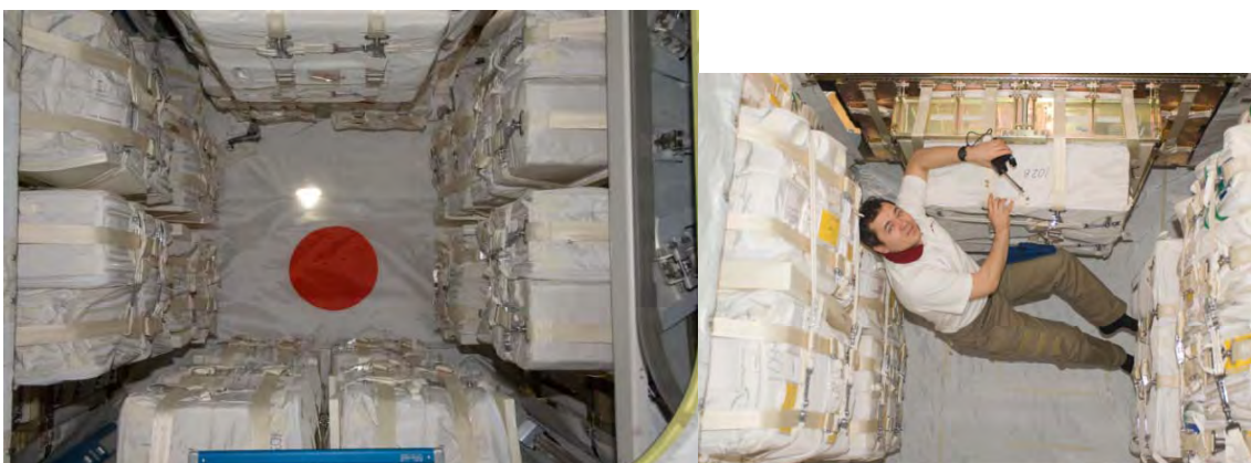
図2.4.1-2 軌道上で撮影された補給キャリア与圧部の内部(左:HTV1、右:HTV2)
