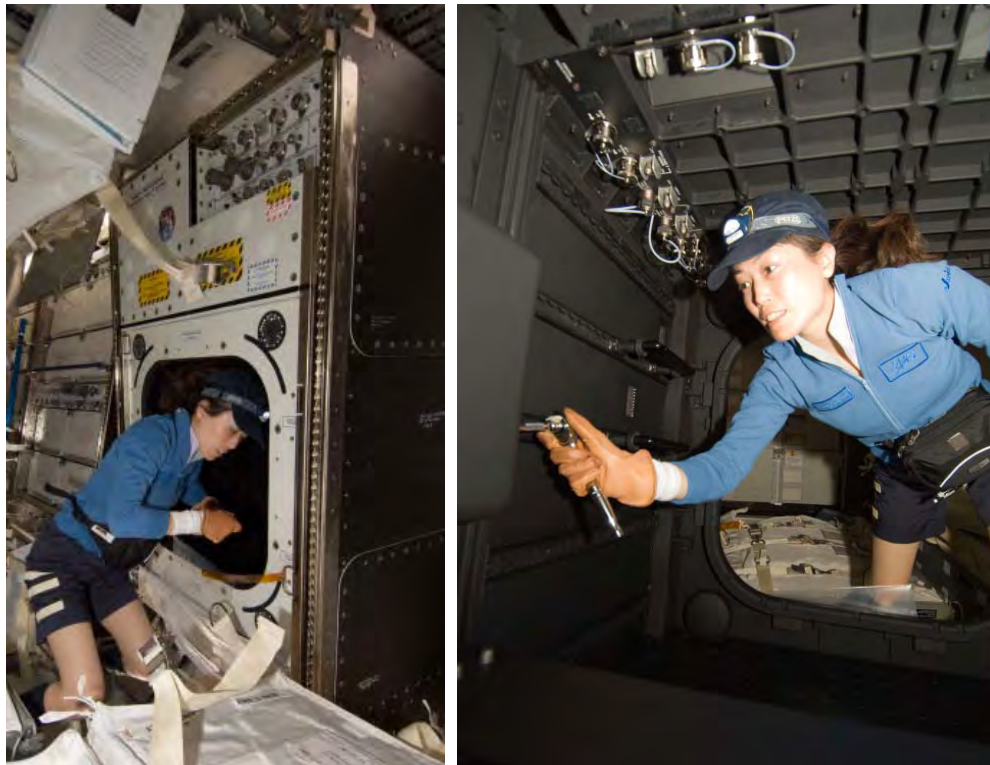
図1.6.1-35 WORF(WORFは窓の上に設置する専用ラックで中は空洞) (左はSTS-131で山崎宇宙飛行士がWORFの搬入準備をしている様子、右はWORF内部)
