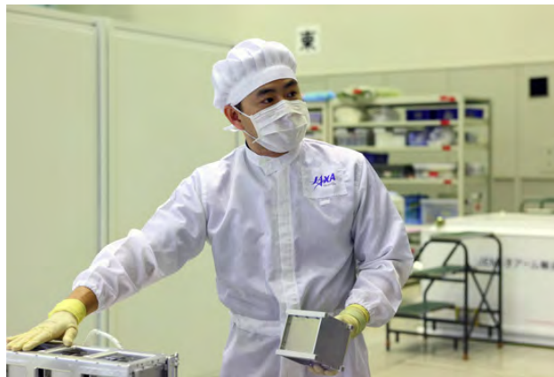
図1.6.1-24 CubeSat (JAXA)(星出宇宙飛行士が手に持っているのが1UサイズのCubeSat)
