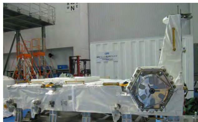
図1.6.2-1 HTV3の曝露パレットに搭載された日米の実験装置(上) (下は実験装置を搭載する前の曝露パレットの写真)
