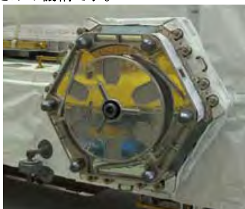
図2.4.3-4 簡易型ペイロード側装置交換機構(HPIU)
