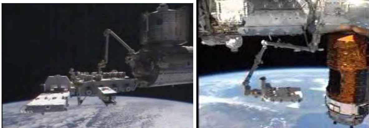
HTV補給キャリア非与圧部に収納される曝露パレット(HTV1)
