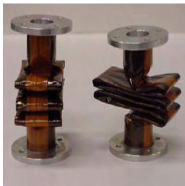
図1.6.2-15(2/3) インフレータブル実験の海外事例 RIGEX(Rigidizable Inflatable Get-Away-Special Experiment) (NASA) STS-123で土井宇宙飛行士がシャトルの貨物室の小型の容器内で伸展させるRIGEX実験を担当
