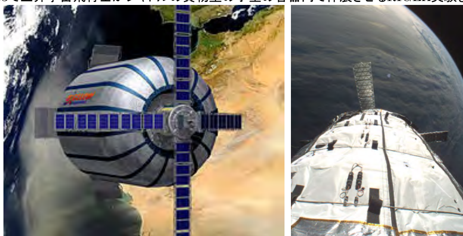
図1.6.2-15(3/3) インフレータブル実験の海外事例 右:ビゲローエアロスペース社の Genesis-I の軌道上写真 [ジェネシスI 2006年7月12日打上げ、ジェネシスII 2007年6月28日打上げ] この試験機を元に大型化した与圧モジュールを2014年に打上げ、宇宙ホテルにする計画
