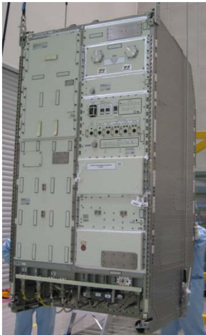
図1.7.1-10 HTV2に搭載される前の勾配炉ラック
