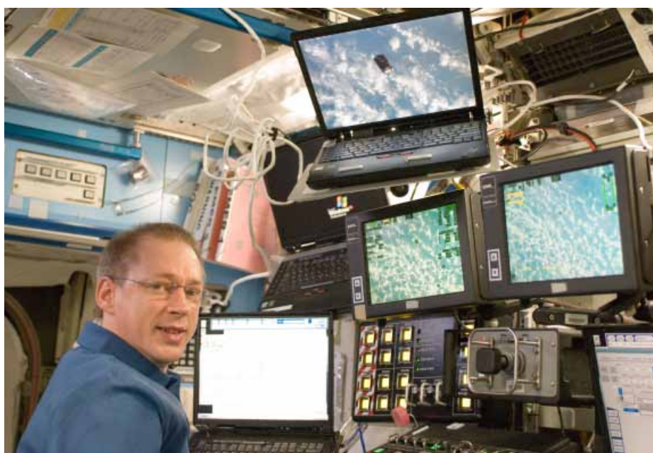
図2.5.2-4 HTVを把持する際に使われるロボットアーム操作卓(HTV1)
