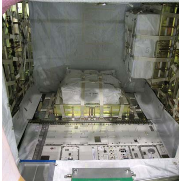
図1.7-1 HTV補給キャリア与圧部(補給物資の積み込み途中)(HTV2)
