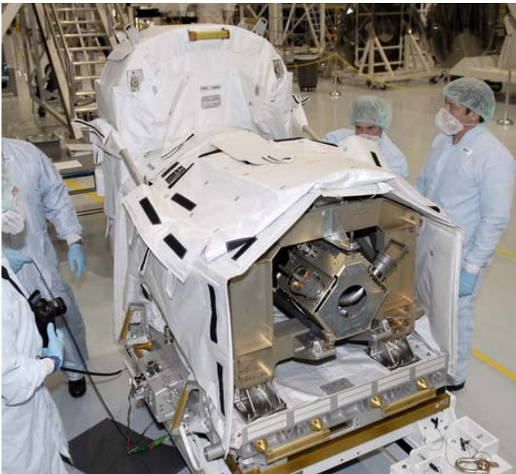
図1.7.2-1 フレックス・ホース・ロータリー・カプラ (FHRC)
