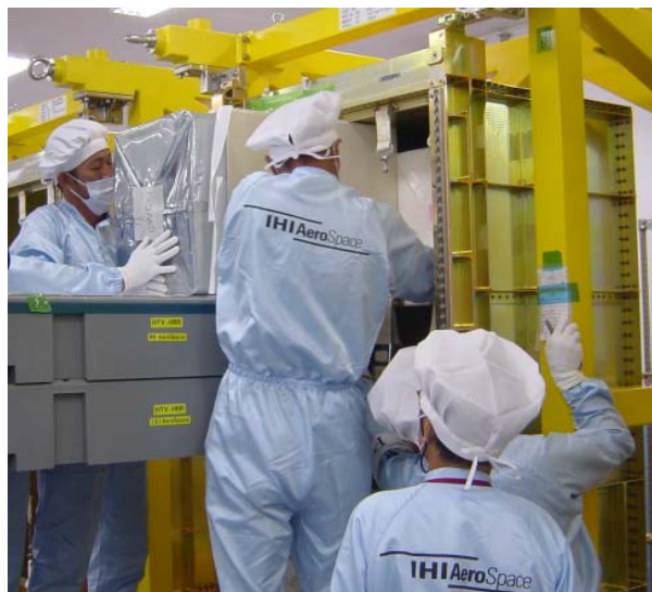
図1.7.1-4 HTV補給ラック(HRR)に搭載される物資輸送用バッグ(CTB)
