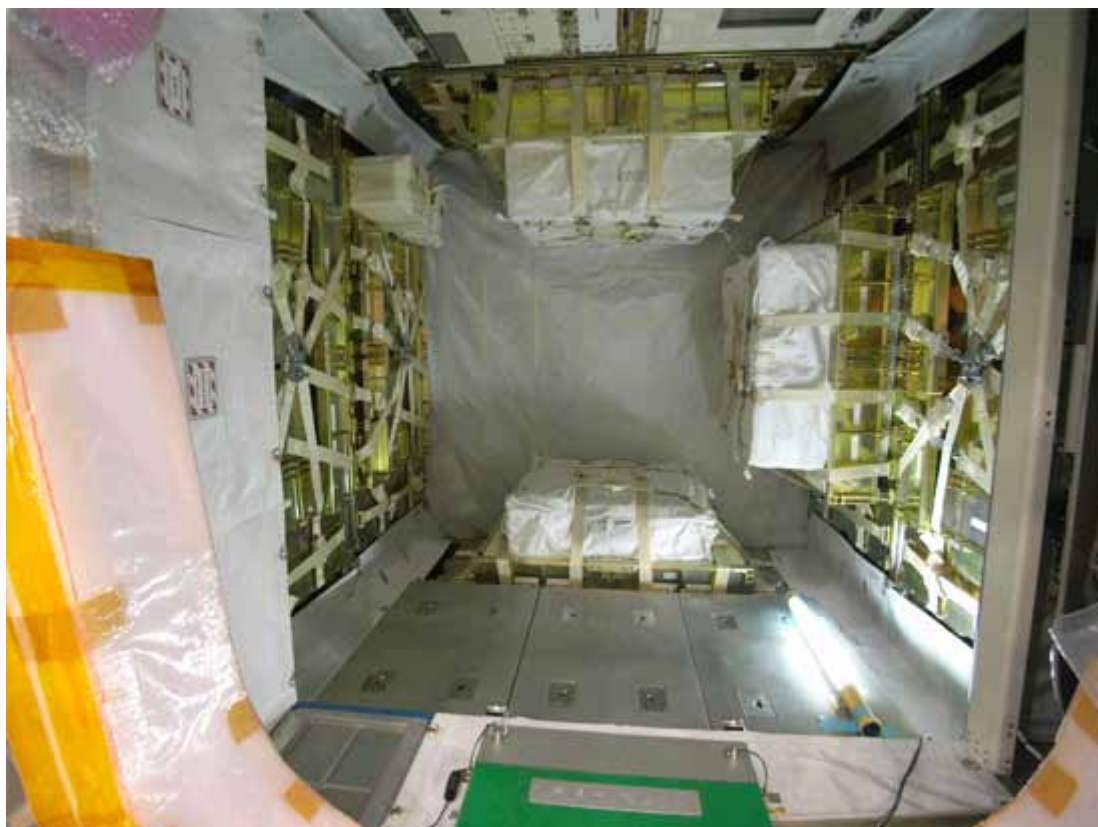
図2.4.1-3 HTV2内部のラック配置(ハッチ側から撮影:積み込み途中)
