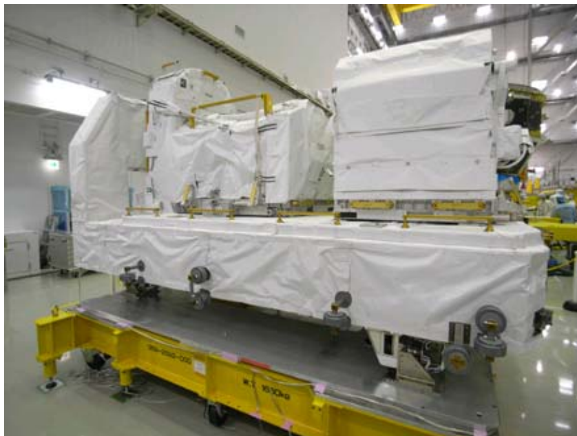
図1.7-2 HTV2の曝露パレット(曝露カーゴが搭載された状態)
