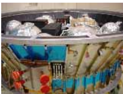
図2.4.5-1 推進モジュール (多層断熱カバー取付け前)
