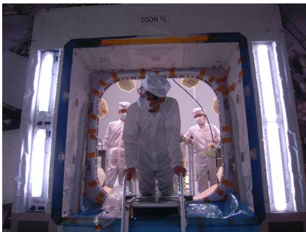
図1.3-1 HTV2から導入されたLED照明(右側の2基)
