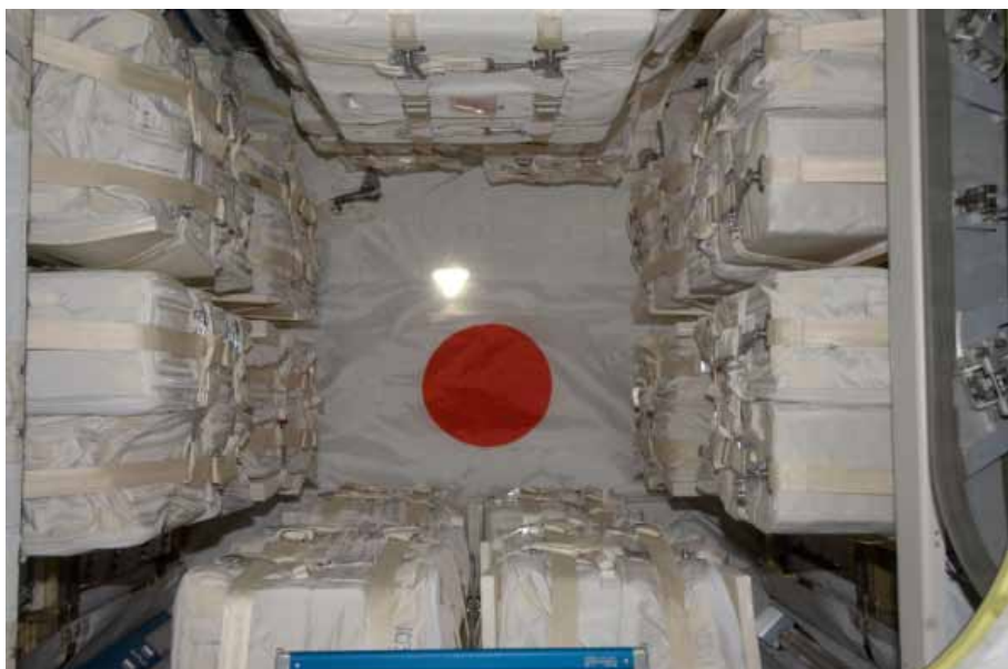
補給キャリア与圧部の内部(HTV1)
