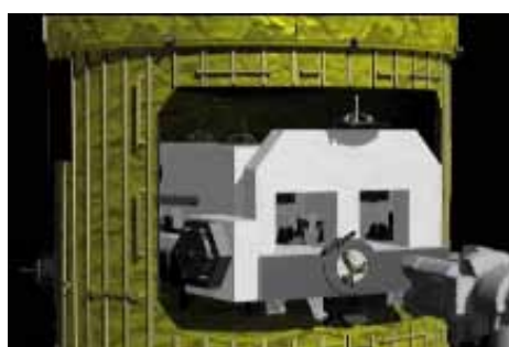
ISSのロボットアームで、曝露パレットをHTV補給キャリア非与圧部から取り出すイメージ(CG)
