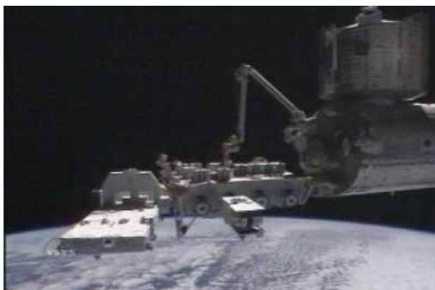
HTV補給キャリア非与圧部に収納される曝露パレット(HTV1)
