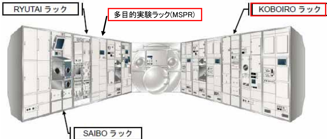
図1.7.1-15 きぼう船内実験室内の実験ラック配置
