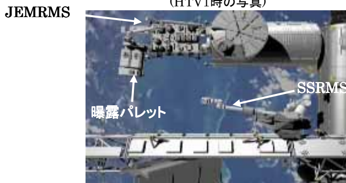
曝露パレットはSSRMSから、JEMRMSに受け渡され、船外実験プラットフォームに取り付けられる (HTV1時の写真)
