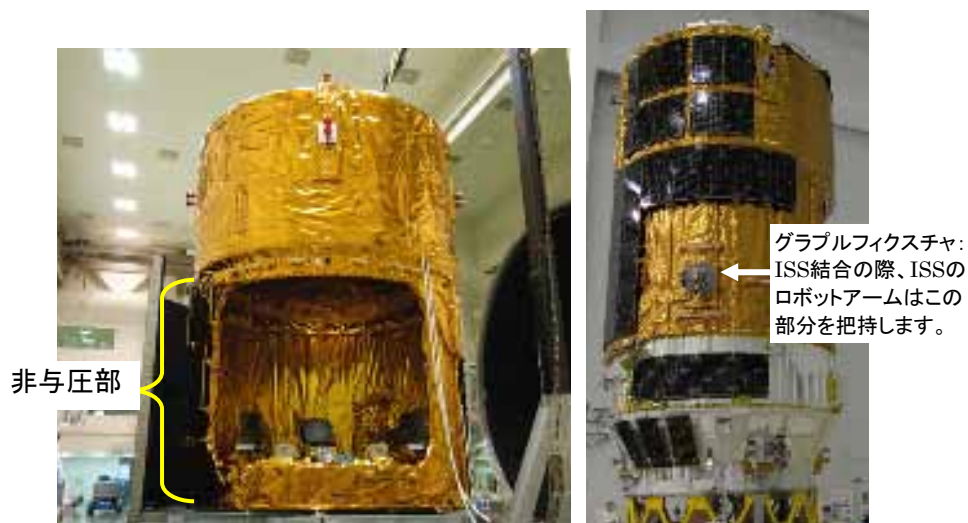
図2.4.2-1 補給キャリア非与圧部(HTV1)(左は曝露パレット搭載前)
