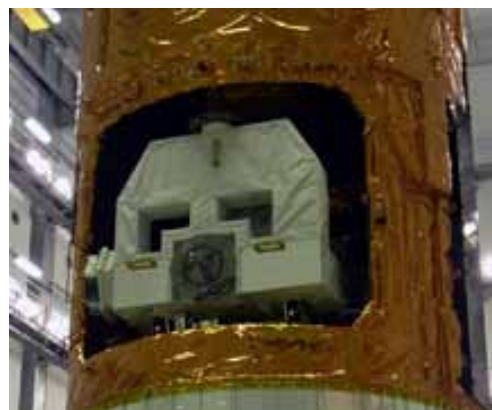
図2.4.2-3 曝露パレットを搭載した状態(HTV2)
