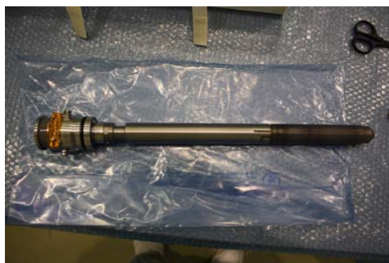
図1.7.1-11 HTV2で運ばれる温度勾配炉チェックアウト用の試験カートリッジ
