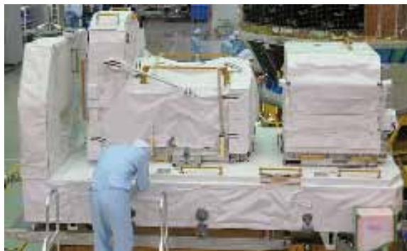
曝露パレット上に搭載されたFHRC(左)とCTC(右)
