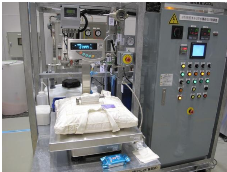
図1.3-3 種子島宇宙センタに設置されたCWCへ水を充填する装置
