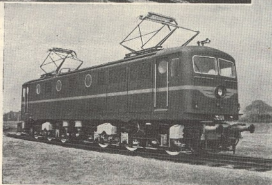
Locomotivas eléctricas de 3830 CV. Uma das 40 fornecidas aos Caminhos de Ferro Britânicos. Fornecedores das peças mecânicas e responsáveis pela montagem Metropolitan-Vickers-Beyer Peacock Ltd.
