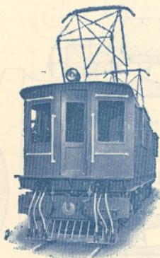
Locomotiva eléctrica de 700 HP, 1.500 V contínuos, fornecida em 1920 para os Caminhos de Ferro de Nova Zelândia
