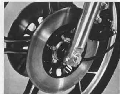
強力なストッピングパワーを発揮するフロントのダブルディスクブレーキ。ニューデザインの下重量も軽減。タイヤは前後ともチューブレス
