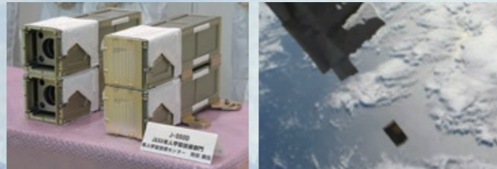
放出能力を倍増させた小型衛星放出機構(J-SSOD)。「きぼう」から放出される「STARS-C」今後も段階的に機能向上を目指す
