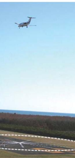
北海道で行った音源計測の様子。50mの範囲に198本のマイクを設置し(画像上)、上空を通過するジェット機の騒音源を計測した(画像下)
