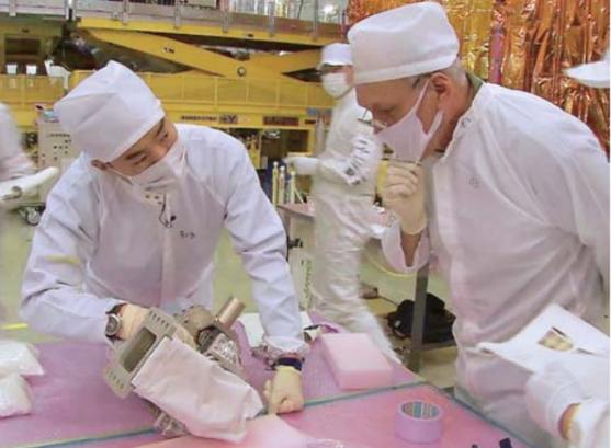
「こうのとりの4号機のフライト・クルー・インターフェース・テスト (FCIT) を実施する野口聡一宇宙飛行士 (左) と NASA 技術担当のハイミー・ファレロ氏 (右)。FCITとは、宇宙飛行士の観点から、実際に打ち上げられる機器が軌道上でも問題なく運用できることを確認するための試験だ
