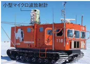
小型マイクロ波放射計は、移動観測、定点観測、計測実験に使用されている
