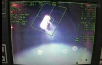
「このとり」3号機のRCSスラスターの噴射の様子。精密なランデブーの鍵を握るのが精密なパルス噴射の技術だ。「個人的には月・惑星探査機でもこのエンジンが活躍してほしい」（中井氏）
