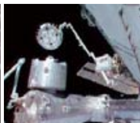
2月18~19日 スペースシャトル「ディスカバリー号」のISSドッキングに備えてISS第2結合部「ハーモニー」の天頂側ポートへ「こうのとりの」2号機を移設
