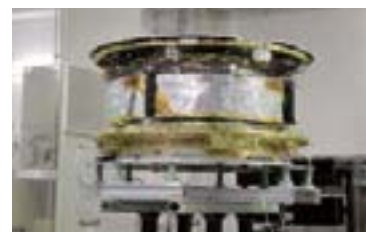
「イカロス」のセイル膜は折り畳まれ、円柱形の本体に巻きつけて収納されている
