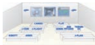
「きぼう」運用管制室での管制員の配置と役割 J-FLIGHT :フライトディレクタ。運用管制に関する責任者。管制員や宇宙飛行士の作業指揮をとる CANSEI :管制、通信、電力系機器担当 FLAT :環境・熱制御系機器担当 KIBOTT :ロボットアーム・機構系機器担当 J-PLAN :実運用計画担当 SENIN :システム担当 TSUKUBA GC :地上設備担当 J-COM :交信担当。管制員からの指示はすべてJ-COMが宇宙飛行士に伝える ARIES :船内活動支援担当 宇宙飛行士の船内の仕事の支援など JEM PAYLOADS :宇宙実験が円滑に行われるよう、実験者の窓口となる
