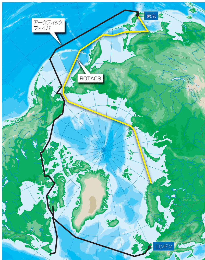
図1 北極海を横断して東京とロンドンを接続する海底ケーブルが2つのルートで計画されている。ポーラーネットプロジェクトの計画は北極海のロシア領海を通過するROTACSケーブルを敷設する(黄色)。アークティックファイバはカナダの北極海沿岸を通過する北西航路を選択した(黒色)。第3の海底ケーブルとして計画されているアークティックリンクも同様のルートを選択する。ROTACSとアークティックファイバは本年中の建設開始を計画している。
