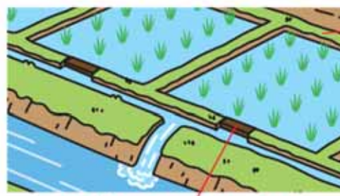
排水口に堰板を使って水の深さの調節ができる
