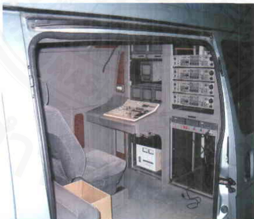
รถ OB VAN (OUTDOOR BROADCASTING) ใช้ในการตัดต่อนอกสถานที่
