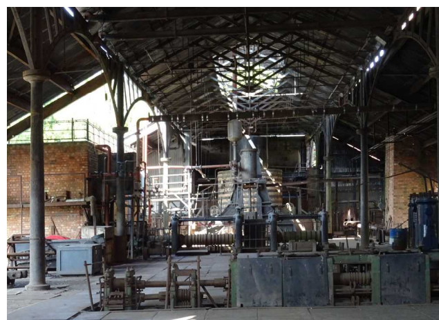
〔写真10〕 錬鉄工場の内部、手前に蒸気ハンマがあり、その後にはパドル炉がある (2019/08/20)
