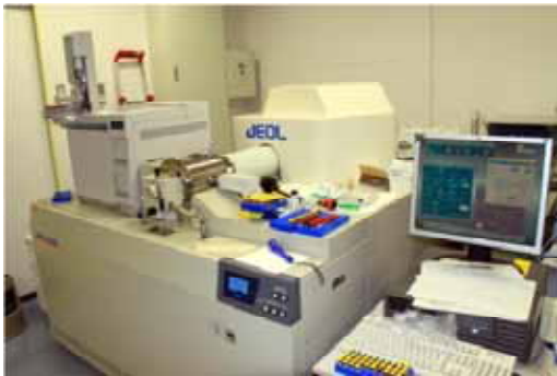
写真：高分解能ガスクロマトグラフ質量分析計で強毒性物質ダイオキシンを検出
