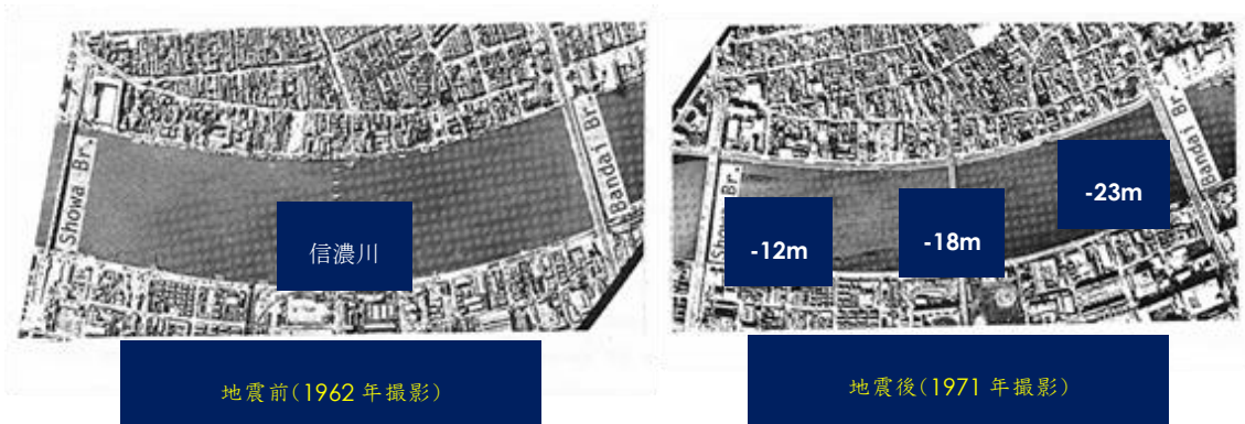
図4 1964年新潟地震によって生じた信濃川沿岸の側方流動に伴う川幅の変化：万代橋付近で川幅は23m狭まった（Hamadaほか3名 Study on Liquefaction Induced Permanent Ground Displacements、ADEP, 1986年11月、より引用）
