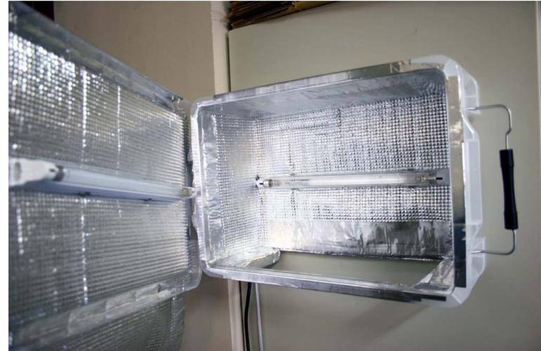
マグネットでスチール製ロッカーなどに貼付け、下から手を入れて両面を同時に不活化。ランプから手指の距離は3cm以下であり、現在使用している器具・ランプの組み合わせ(5 cm で  $1.5 \text{ mW/cm}^2$  以上を保証)では、**5秒以下**で1/10,000まで不活化が可能。手を上げていくと手首部分の不活化も可能。
