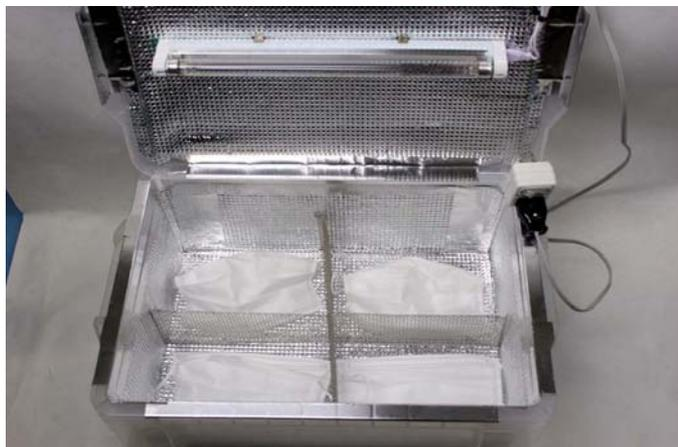
マスクが極度に不足していた時期に、医療機関で安全にマスクを再利用するために開発したのがマスククリーン4。殺菌灯をアルミシート貼りした箱に入れただけのものであるが、当時殺菌灯用の蛍光灯器具の入手もままならなかった。大量に輸入した中華製の製品は極めて品質が不安定であったが、ランプを国産の物に変えることで概ね安定した値を示すことが判明。さらに、ラジオクロミック線量計などを用いて、照射強度(線量率)を評価、10mJ/cm<sup>2</sup>照射するのに必要な時間を安全側に評価して保証した(マスククリーン4では20秒)
