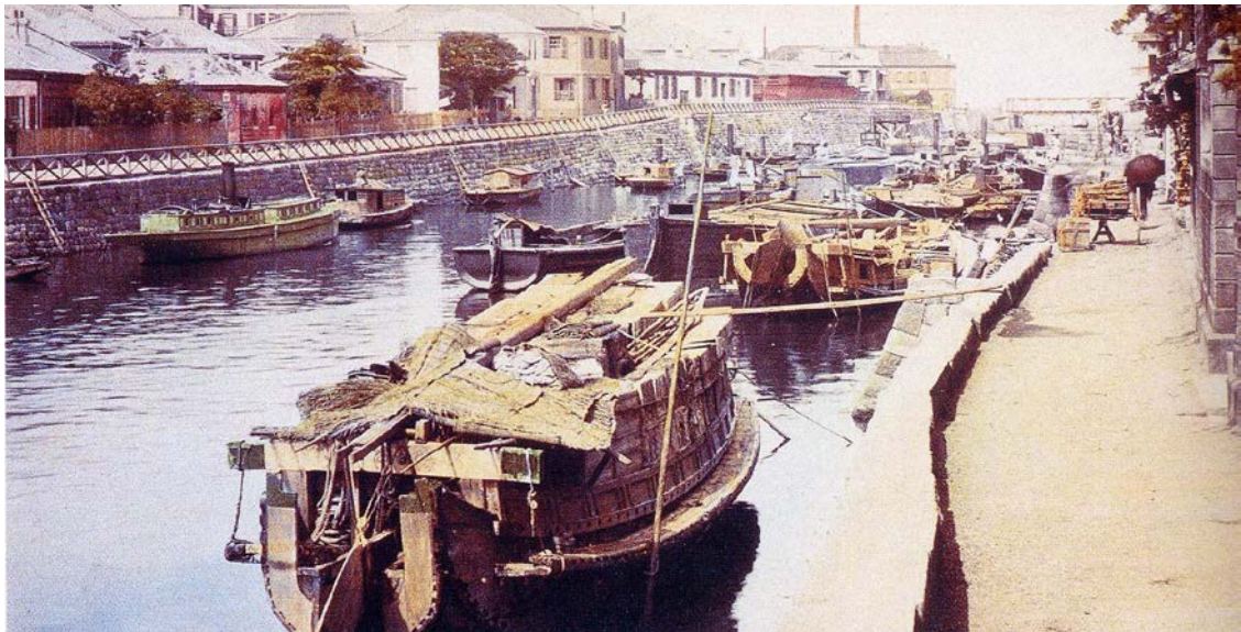
横浜本町(元町)堀川に碇泊する五大力船。 (右舷に長い棹走りが見られ、帆柱は倒され、舵は引き上げられている) 『日本の船 和船編』より
